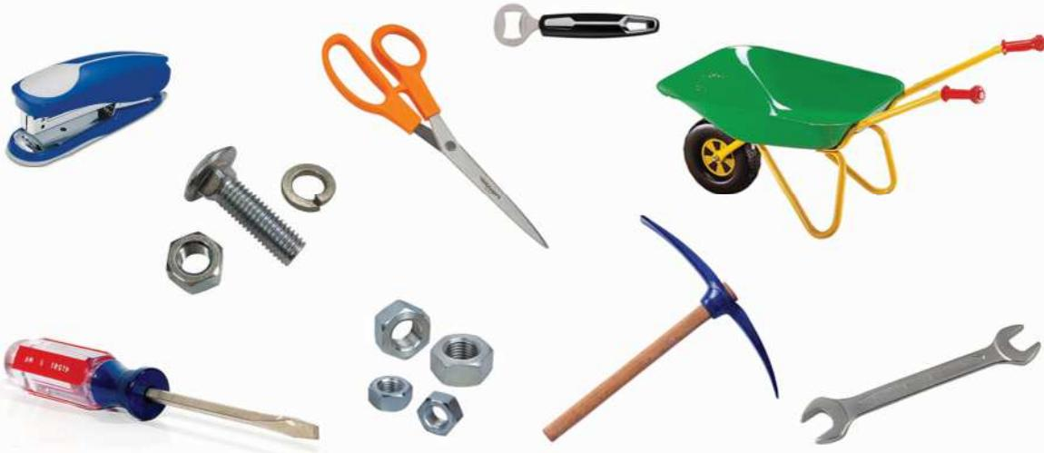
وسیله‌هایی مانند الکلنگ و ترازو اهرم هستند. قیچی، میخ کش، انبر دست، پیچ گوشتی، کارد و منگنه مانند اهرم عمل می‌کنند.
